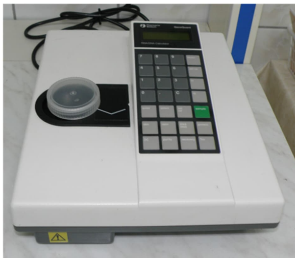
Rys. 1.3a. Spektrofotometr do pomiaru zawartości i oceny czystości kwasów nukleinowych.
